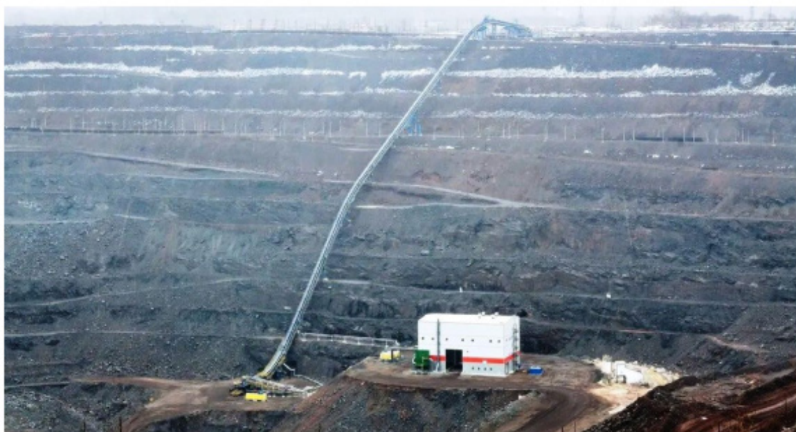
Hình 3. Tổ hợp nghiền và băng tải tại Mikhailovsky GOK (LB Nga) với công suất 25 triệu tấn/năm
